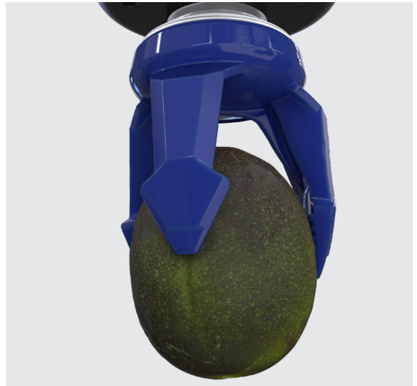
piSOFTGRIP® отлично подходит для захвата хрупких предметов и для работ с извлечением предметов из бункера.
